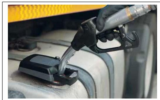
Un système de ressort referme automatiquement le bouchon
