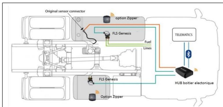
Ce dispositif conserve les caractéristiques du véhicule sans les altérer et s'intègre parfaitement aussi bien sur le plan technique qu'esthétique avec la majorité des poids lourds du marché. L'installation ne requiert pas de perçage du réservoir conservant ainsi ses caractéristiques homologuées d'origine.
